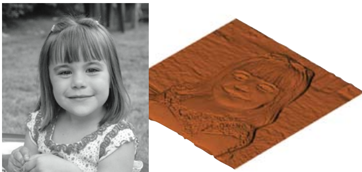
Mastercam Art nabízí výkonné, snadné umělecké nástroje včetně možnosti vytvářet 3D model přímo z digitálního obrázku. Naskenujete fotografii a Mastercam Art vytvoří reálný 3D model použitím různých barevných odstínů pro definici výšek a hloubek.
